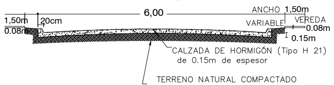
PERFIL TIPO CALLE DE 6 METROS (entre av. Colon y calle Publica N°4)
